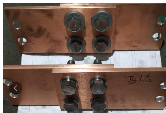
100x10 (退火态) M16 螺栓螺母平弹垫组 (下) 和螺栓螺母瓦垫组 (上)
